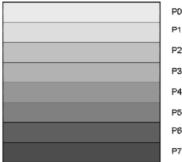
図 2 行列の各プロセッサへの領域分割の概念図
