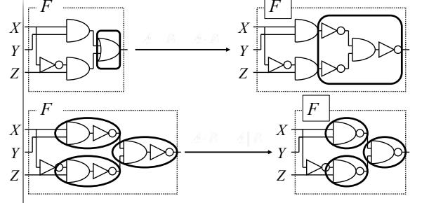
AND-OR回路→NAND回路変換はゲートの入れ替えだけ
