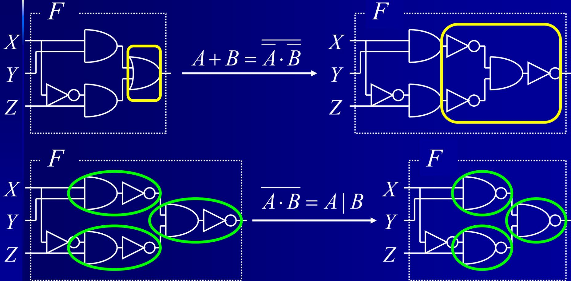
AND-OR回路 → NAND回路変換はゲートの入れ替えだけ
