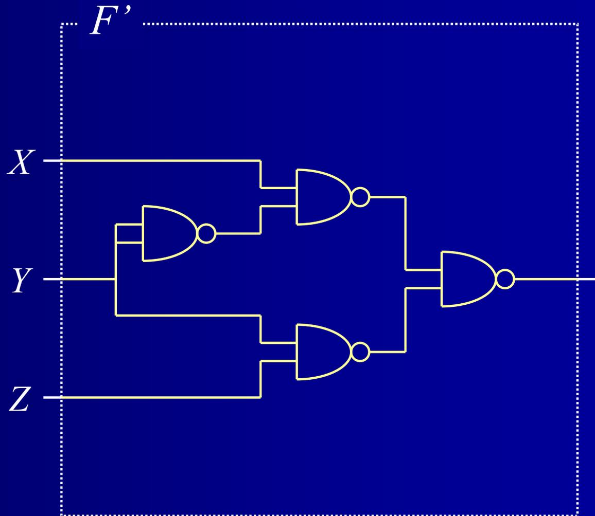
AND-OR回路→NAND回路変換はゲートの入れ替えだけ
